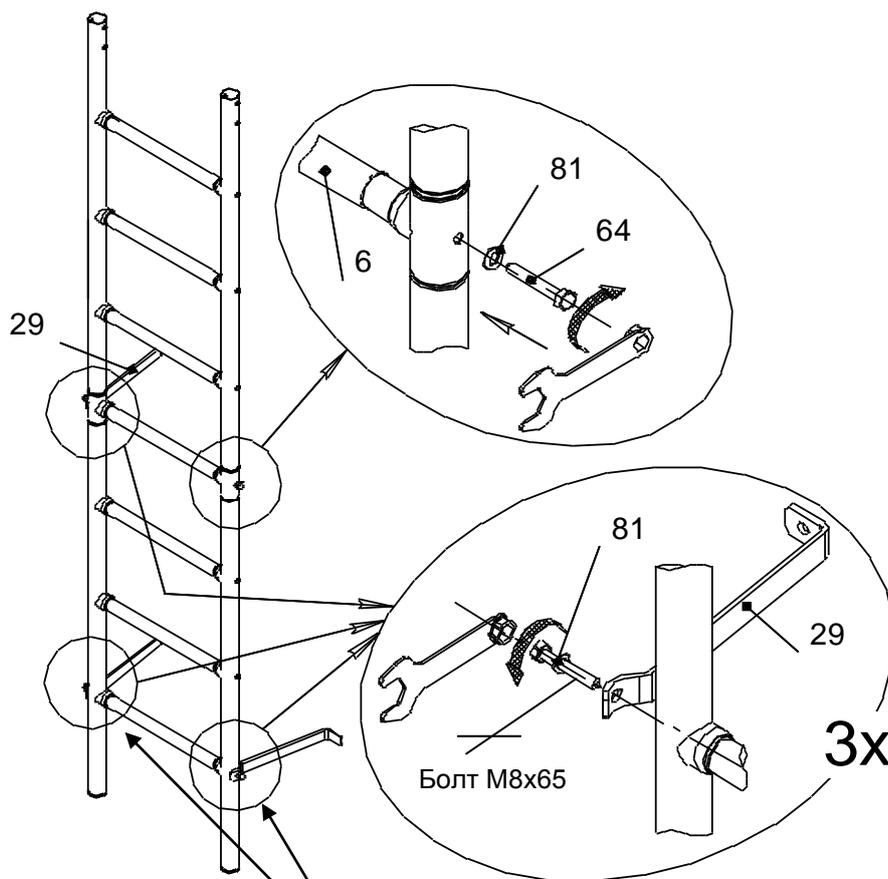
Открутить на нижней ступени болты M8x65, приставить кронштейны поз. 29. Закрепить ступень и кронштейны снятыми болтами с шайбами поз. 81.
